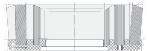
Borsten kan även profileras för att passa fälgens profil.
